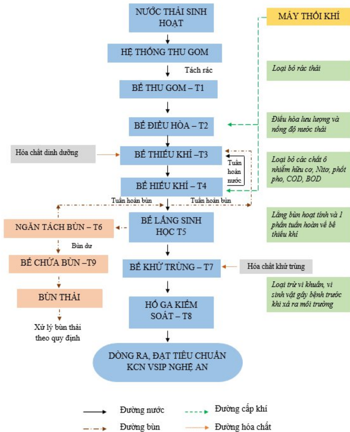
Hình 6. Sơ đồ quy trình xử lý nước thải sinh hoạt công suất 500 m 3 /ngày đêm
